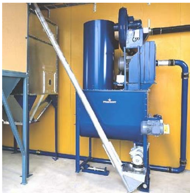
Billedet viser et PHB8-4KSF kompaktanlæg på vejeceller med selvrensende filter, ventilator, cellesluse og snegl for videretransport
