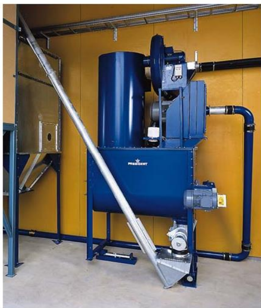
Billedet viser et President kompaktanlæg, hvor mølle, blander og filter er samlet til en enhed.
