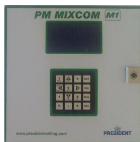
Das Bild zeigt eine President Mahl- und Mischanlagesteuerung PM Mixcom M1.
