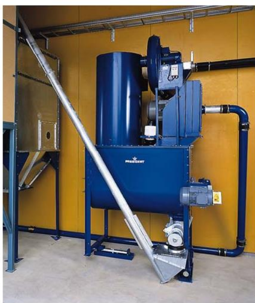
Das Bild zeigt eine President Kompaktanlage, wo Mühle, Mischer und Filter zu einer Einheit gesammelt sind.
